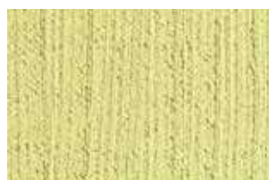
Нанесение с помощью кисти
